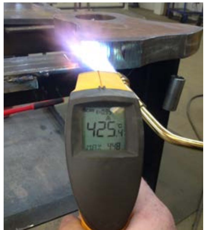
Figura 10: Medição da temperatura durante o pós-aquecimento.
