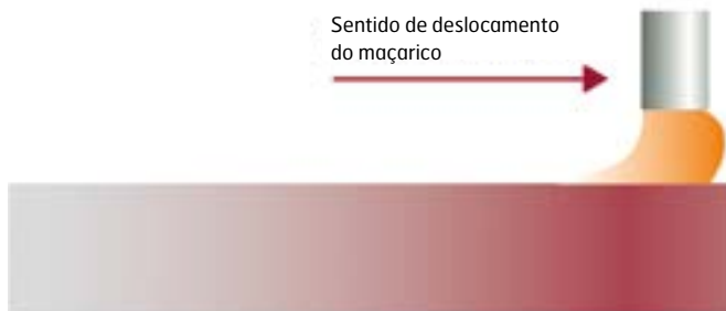
Figura 8: Cor da borda cortada atrás do maçarico de pós-aquecimento.
