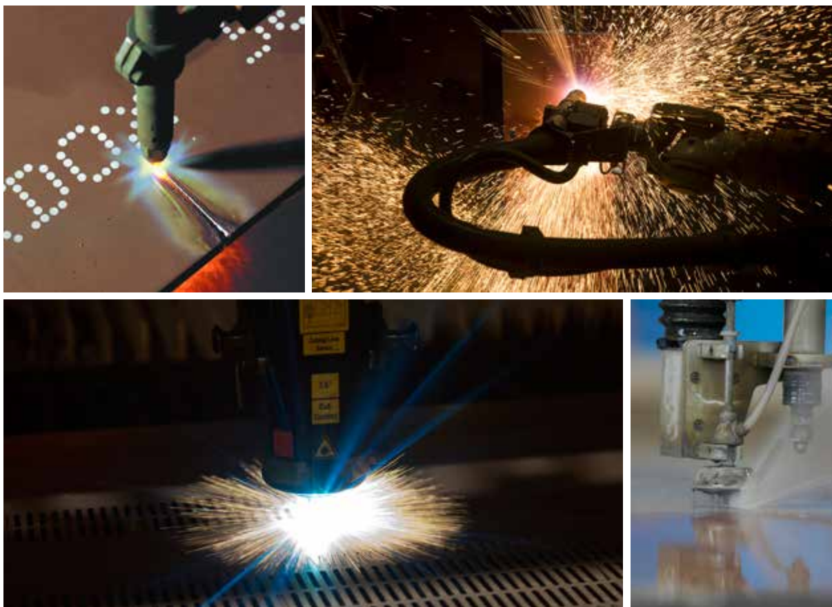
RYSUNEK 1. Od góry, od lewej strony: cięcie tlenem, cięcie plazmą, cięcie laserem, cięcie AWJ
