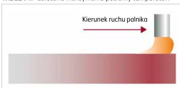
RYСУNEK 6. Kolor krawędzi cięcia za palnikiem do podgrzewania po cięciu.
