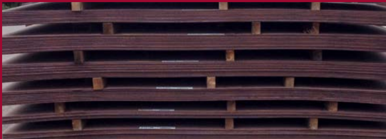
Figura 13b: Chapas apiladas incorrectamente.
