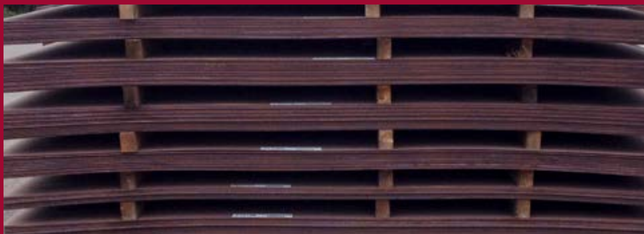
Figura 13a: Chapas apiladas correctamente.
