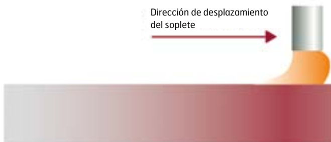
Figura 8: Color del borde cortado por detrás del soplete de postcalentamiento.
