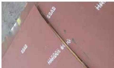
Exemplo de uma força de três pontos durante o armazenamento.
